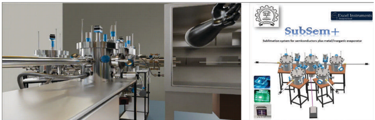
चित्र 7.3 SUBSem+ — पेरोव्स्काइट और पेरोव्स्काइट-सिलिकॉन 2T टैंडम सौर सेलों के स्वचालित निर्माण के लिए एक विशेष उपकरण।
