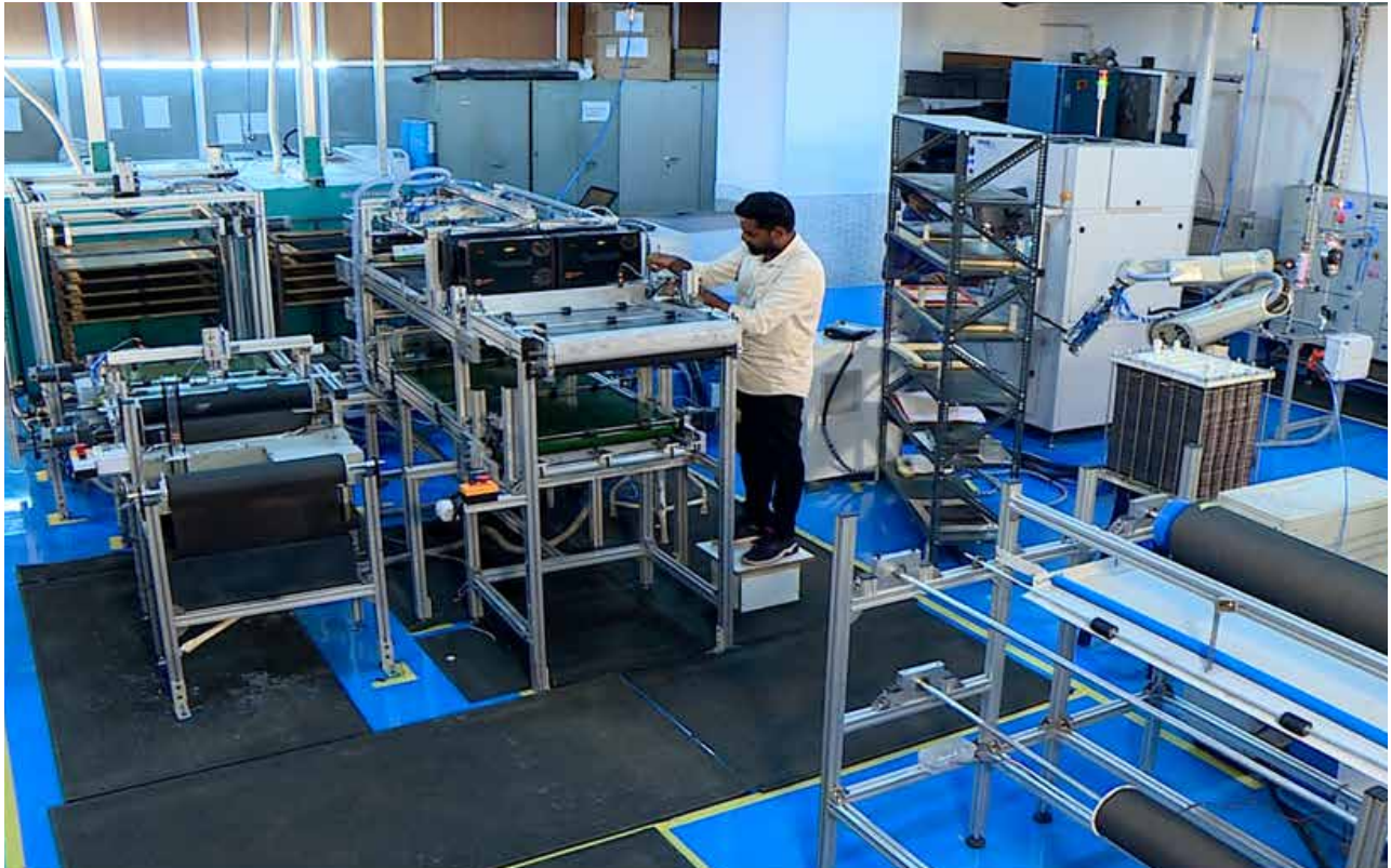
चित्र 3: एआरसीआई-सीएफसीटी, चेन्नई में स्थापित पीईएमएफसी घटक/स्टैक असेंबली प्रायोगिक लाइन
