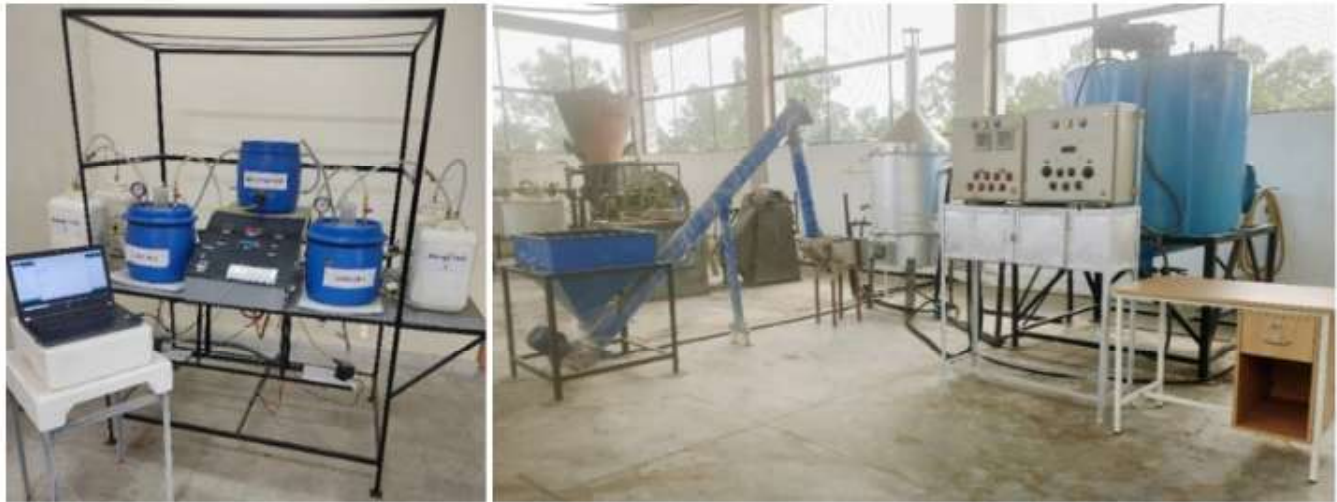
चित्र 9.17: (क) स्मार्ट हाइब्रिड एनारोबिक डाइजेस्टर का लैब-स्केल मॉडल (प्रथम चरण); (ख) स्मार्ट हाइब्रिड पायलट-स्केल बायोगैस प्लांट (द्वितीय चरण)
