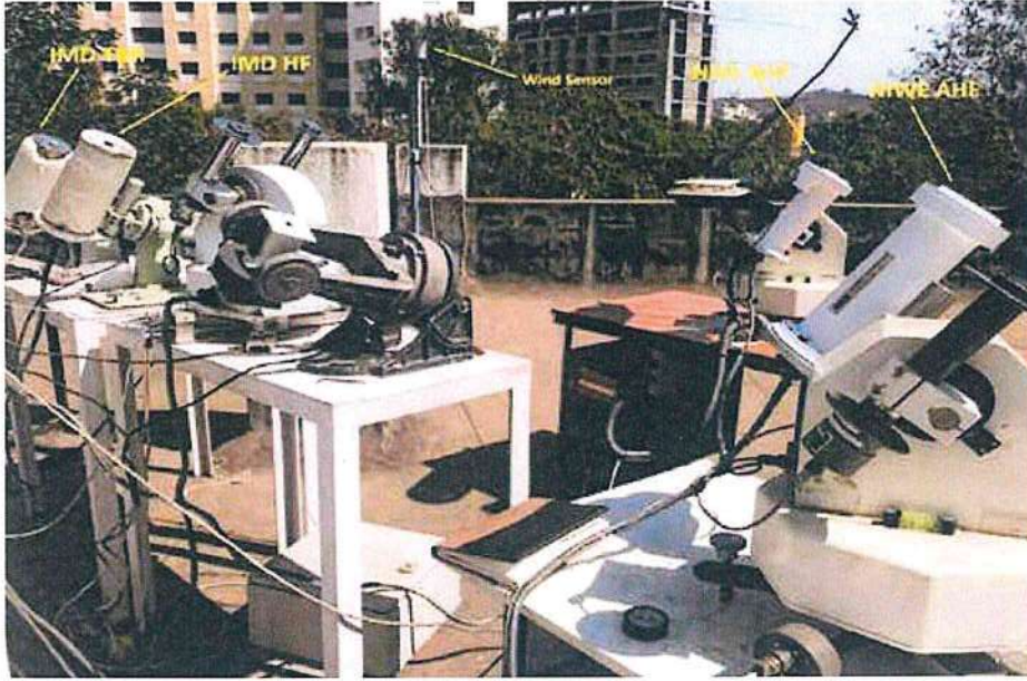
मार्च 2018 में नाइस, नीवे और आईएमडी पुणे की केलिब्रेशन प्रयोगशाला में प्राइमरी स्टैंडर्ड रैफ़्रेंस सेंसर का राऊण्ड रॉबिन परीक्षण
