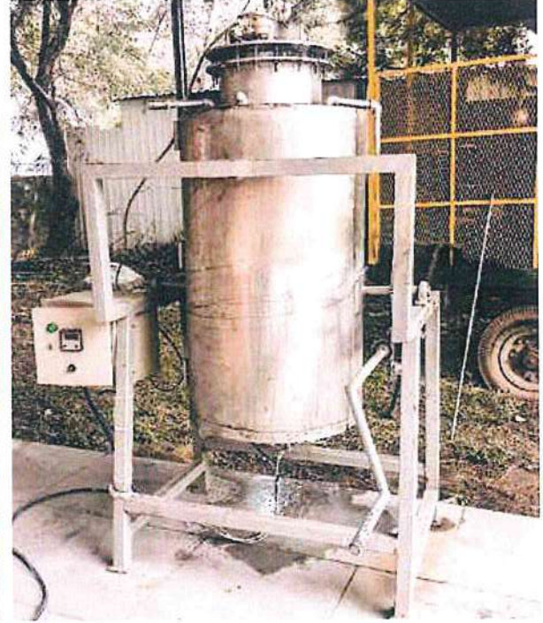
आईआईटी, दिल्ली में 50 एल क्षमता के क्षेत्र स्केल हाइड्रो थर्मल रिएक्टर
