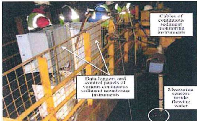
हाइड्रो पावर संयंत्र के डिस्ट्रिब्यूटिंग चौंकर के नीचे की ओर स्थापित सतत सेडीमेंट मॉनीटरिंग यंत्र
