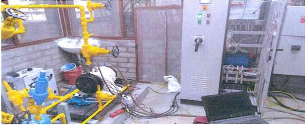
चित्र 7.12: जनरेटर के साथ टरबाइन-कंप्रेसर विधानसभा का मोटर मोड परीक्षण
