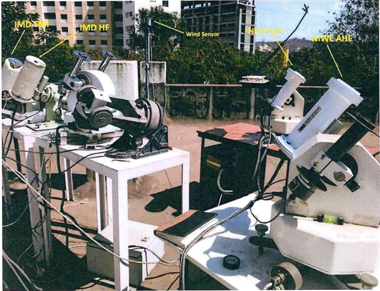
मार्च, 2018 नाइस, नीवे तथा आईएमडी, पुणे में कैलीब्रेशन प्रयोगशाला से प्राइमरी स्टैंडर्ड रिफरेंस सेंसर का राउंड रॉबिन परीक्षण
