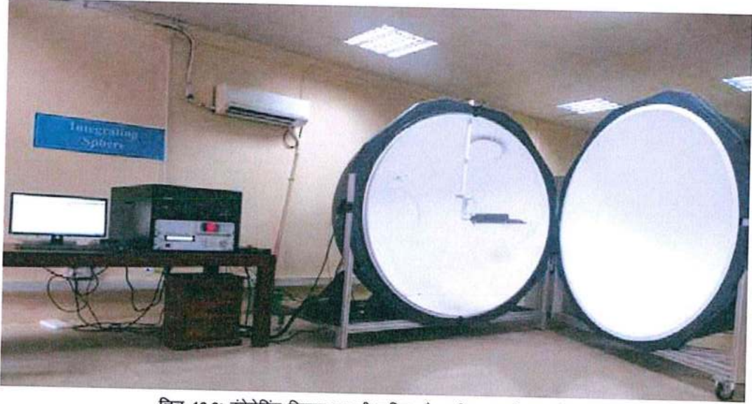
चित्र 10.3: इंटीग्रेटिंग स्फियर प्रणाली सहित सौर स्ट्रीट लाइटों का परीक्षण
