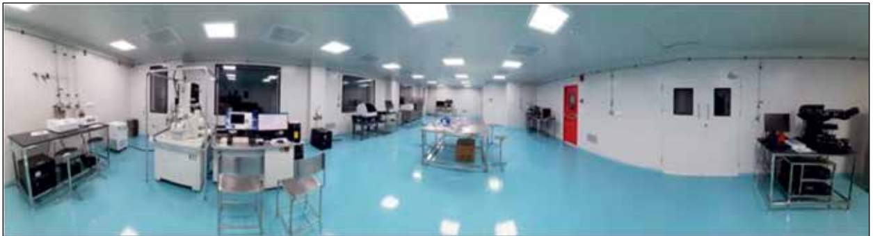
चित्र 10.3: नाइस में आईएसओ श्रेणी 8 क्लीन रूम सुविधा के साथ उन्नत सौर सेल कैरेक्टराइजेशन प्रयोगशाला
