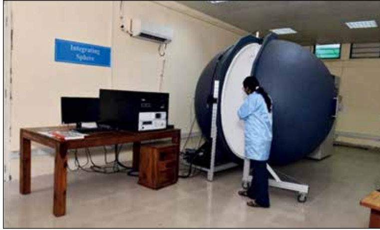
चित्र 10.2: इंटीग्रेटिंग स्फ़ेयर प्रणाली के साथ सौर स्ट्रीट लाइटों का परीक्षण
