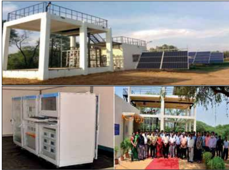
चित्र 10.4: नाइस में 10 एचपी (ऊपर), और 50 एचपी (नीचे) तक के लिए सौर जल पंप परीक्षण सुविधा
