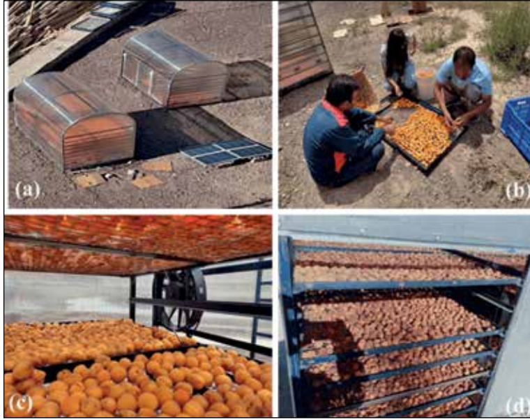
चित्र 10.5: मिनी ग्रीन हाउस आधारित सौर ड्रायर: (क) लद्दाख में क्षेत्र परीक्षण, (ख) मेष ट्रे पर खुबानी को रखना, (ग) ताजा खुबानी को ड्रायर के भीतर रखना, (घ) ड्राइंग प्रोसेस के दौरान खुबानी
