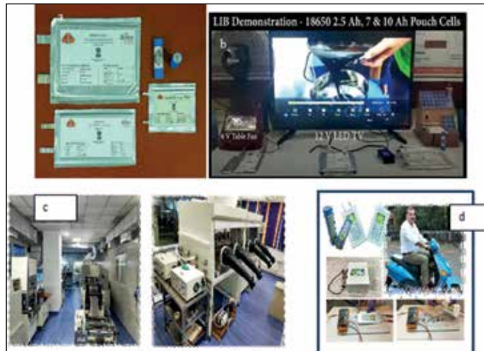
चित्र 7.4: (क) 14 और 7 एच एनएमसी/ग्रेफाइट लि-ऑयन पाउच सेल, लि-सिलिकॉन पाउच सेल और 2.5–2.8 एच एनएमसी/ग्रेफाइट लि-ऑयन सिलिंड्रिकल सेल का नमूना (ख) टेलीविजन, एलईडी और टेबल फैन तथा भविष्य में अलग-अलग घरों में इसका उपयोग, (ग) आईआईटी, बॉम्बे में स्थापित विश्वस्तरीय सेल निर्माण सुविधा, और (घ) सुरक्षित लिथियम ऑयन बैटरी और इसके प्रदर्शन के साथ एक स्टार्ट-अप “विर्या बैटरिस” निर्मित।
