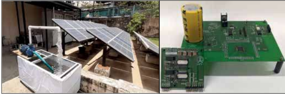
(क) विकसित बीएलडीसी पंप की फील्ड टेस्टिंग (ख) जीएएन आधारित मोटर ड्राइवर
