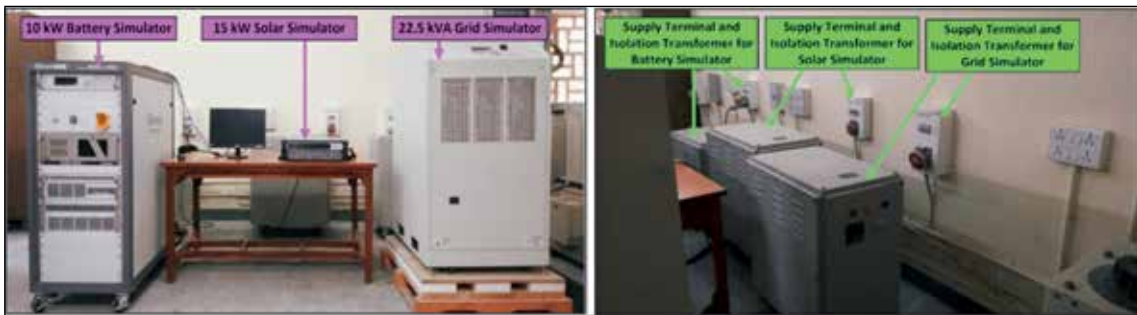
चित्र 7.6: सौर इन्वर्टरों का परीक्षण करने के लिए सोलर एम्युलेटर, बैटरी एम्युलेटर और एक इलेक्ट्रॉनिक लोड का व्यापक टेस्ट बेंच बनाया गया है।
