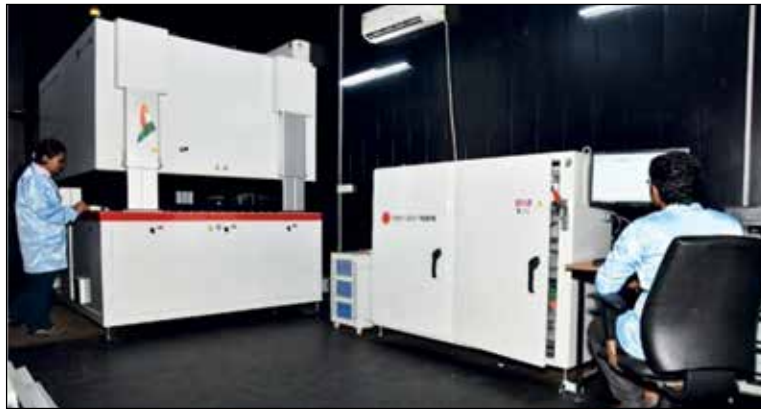
चित्र 10.1: 650 वाट तक के पीवी मॉड्यूलों की टेस्टिंग के लिए तापमान नियंत्रित सन सिमुलेटर
