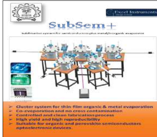
चित्र 7.5: अत्यंत रीप्रोड्यूसिबल पेरोस्काइट ओप्टोइलेक्ट्रॉनिक उपकरणों को बनाने के लिए स्वदेश निर्मित क्लस्टर टूल की स्कीमेटिक
