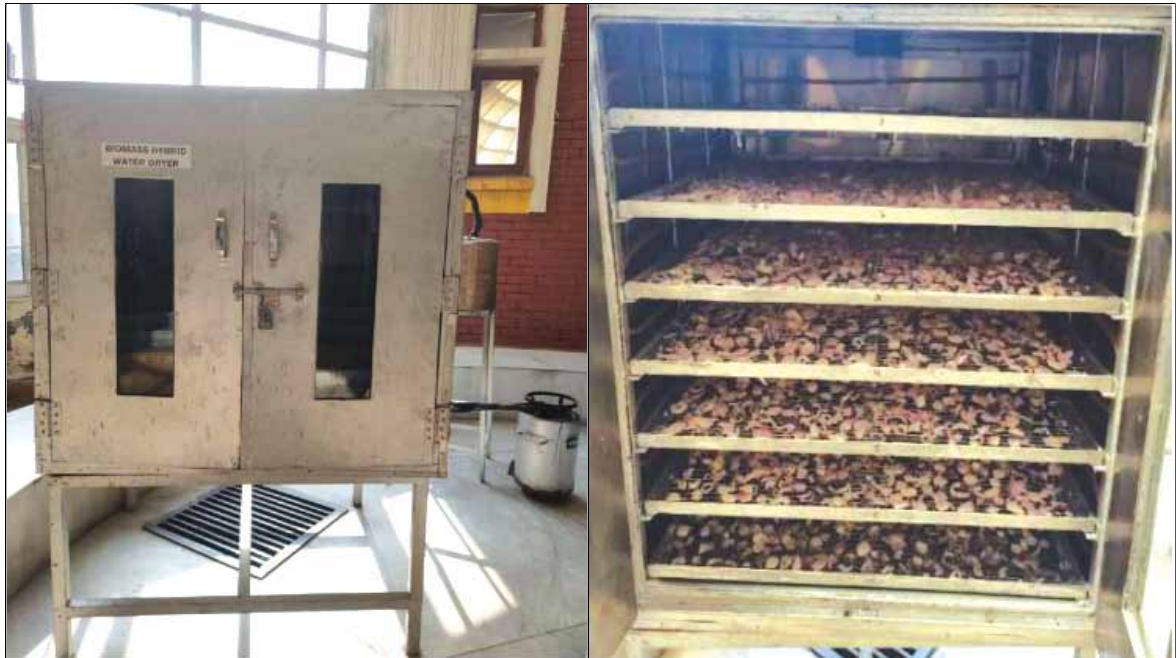
चित्र 10.25: बायोमास हाइब्रिड ड्रायर और बायोएनर्जी का उपयोग करके प्याज के टुकड़ों को सुखाना
