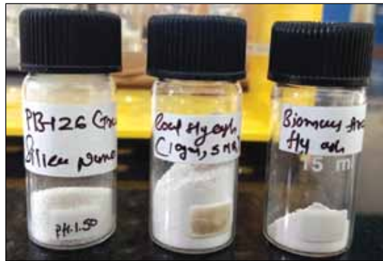
चित्र 10.29: चावल के भूसे (पीबी 126), औद्योगिक कोयला फ्लायैश और जलाए गए बायोमास फ्लायैश से निकाले गए एसआईओ 2 नैनोकण
