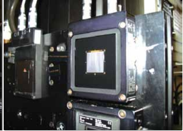
चित्र 7.10(ख): प्रणाली –070–2016, सी-एसआई रैखीय सेल के प्रदर्शन का मूल्यांकन करने के लिए उपयोग किया गया डब्ल्यूपीवीएस संदर्भ सौर सेल
