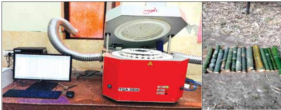
चित्र 10.24: ऑटोमेटिक प्रोक्सिमेट एनालाइजर (बाएं) और त्रिपुरा से एकत्रित विभिन्न बांस प्रजातियां
