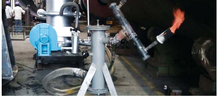
» चित्र 1: यह गैसीफायर लगभग 4.2 किलोग्राम ब्रिकेट द्वारा 1 किलोग्राम रसोई गैस की जगह लेता है
