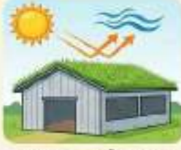
कुक्कुट शेडवर गवताचे आच्छादन छतावर गवताचे आच्छादन करावे.
