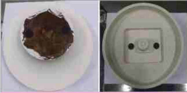
उच्च ताप आसंजक का प्रयोग करते हुए अलुमिना से सतह को सीलबंद करने का ऊपरी और निचला दृश्य
