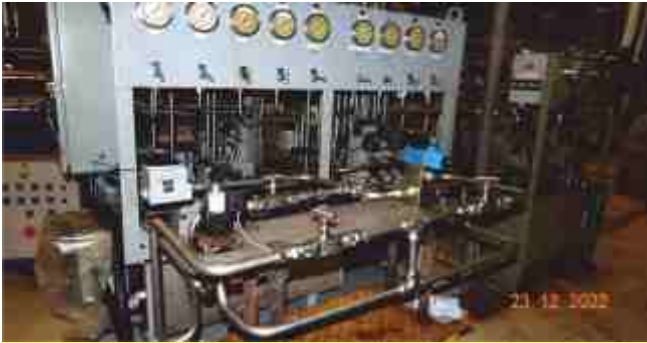
एफएमटीएफ में आनुपातिक प्रवाह नियंत्रण वाल्व परीक्षण
