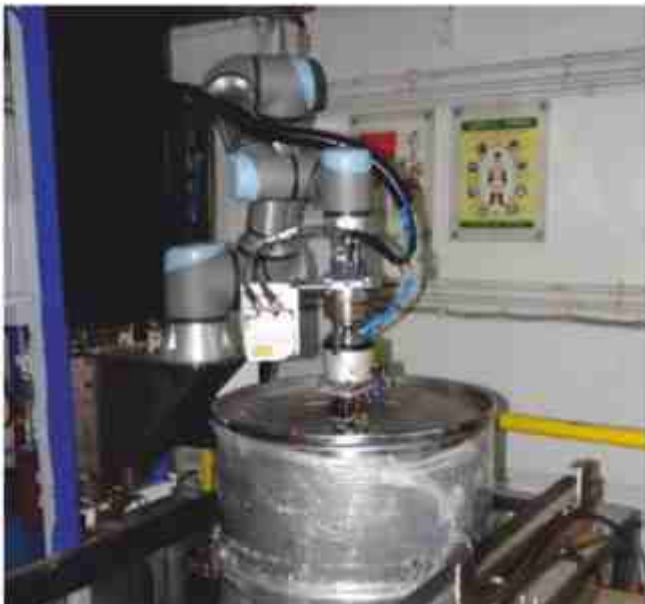
D 2 O भंडारण ड्रमों को दूर से भरने और खाली करने वाले प्रचालन कार्यों में प्रयुक्त होने वाले भापाअकेंद्र में तैयार स्वचालित ड्रम प्रहस्तन प्रणाली।
