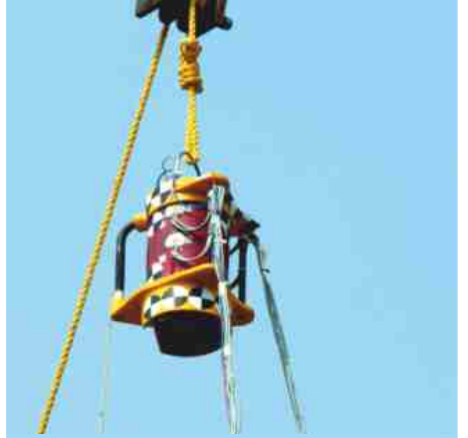
ड्रॉप परीक्षण हेतु 9 मीटर की ऊंचाई पर लटकाया हुआ रोटेक्स-1 उपकरण (क्लोजप दृश्य)
