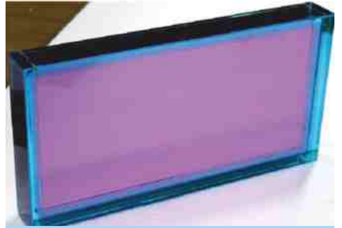
320 mm x 170 mm x 40 mm आकार के एज क्लैड एनडी : ग्लास डिस्क
