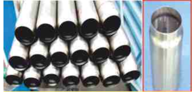
(Zr-1%Nb) नलिकाओं का निर्माण और प्रतिलोम फॉर्मिंग
