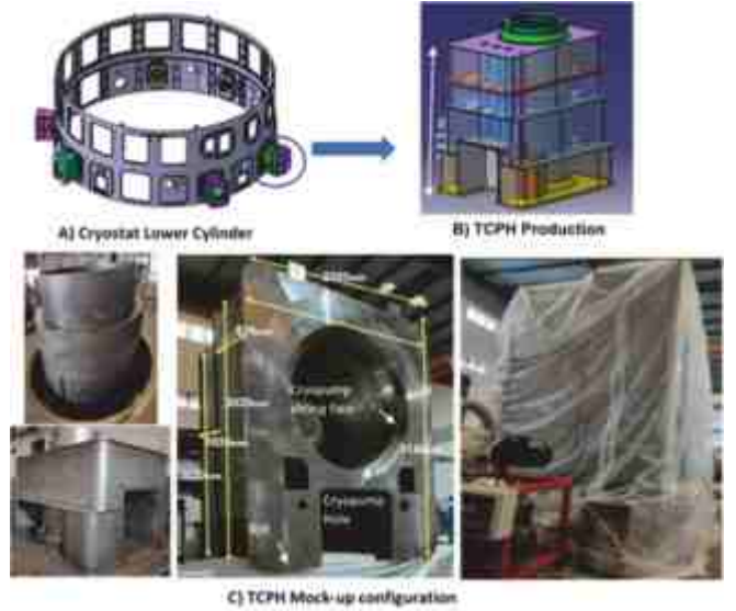
मेसर्स वैक्यूम टेक्निक्स, बेंगलूर में अर्ध आकारित टीसीपीएच माड्यूल का निर्माण, असेंबली और परीक्षण
