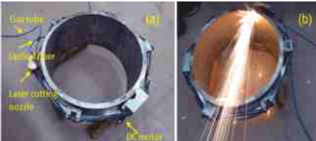
लेजर कटिंग टूल और 30 mm मोटे तथा 700 mm त्रिज्या का मॉक ट्रायल। 1kW औसत पावर ND:YAG लेसर का प्रयोग करते हुए टीएपीएस 1 व 2 में रिसर्कुलेशन लूप की कटिंग के लिए SS316L नलिका
