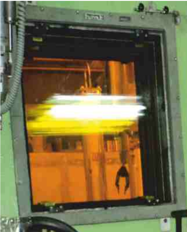
तारापुर स्थित एकीकृत नाभिकीय पुनर्चक्रण संयंत्र (INRP) की नवनिर्मित विकिरण परीक्षण खिड़की।
