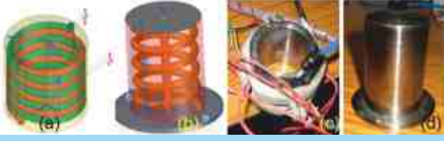
(a) बाह्य (b) आंतरिक और एलएम निर्मित पार्टस (c) बाह्य (d) आंतरिक हेतु कन्फर्मल कूलिंग चैनल कैड मॉडल
