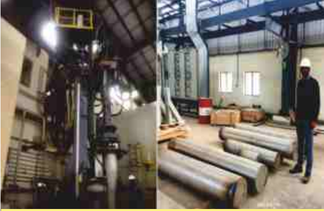
निर्वात चाप पुनर्गलन भट्टी के साथ गलन परीक्षण
