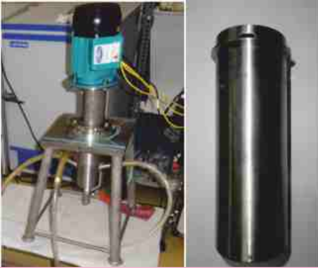
एकल चरण ACE 60 mm सेटअप (a) ड्राइवसहित पूर्ण ACE सेटअप (b) 60 mm ID ACE रोटेटिंग बोल का छायाचित्रिय दृश्य
