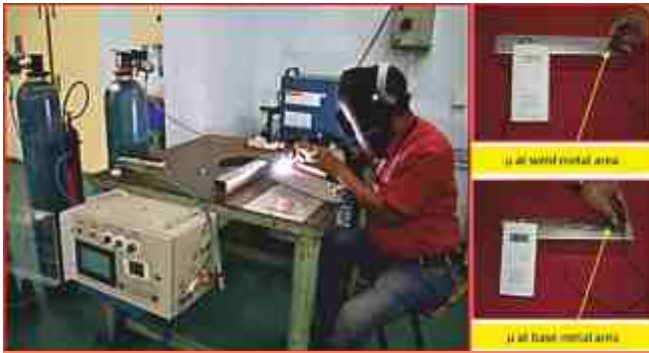
बाइनरी गैस मिक्सिंग सिस्टम का प्रयोग करते हुए वैक्यूम चैम्बर की जीटीए वेल्डिंग
