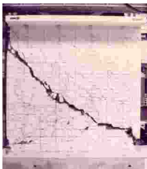
चित्र-11 : कॉन्फाइन्ड भवन की दीवारों में कर्तन ध्वस्तीकरण की स्थिति ( 3 )
